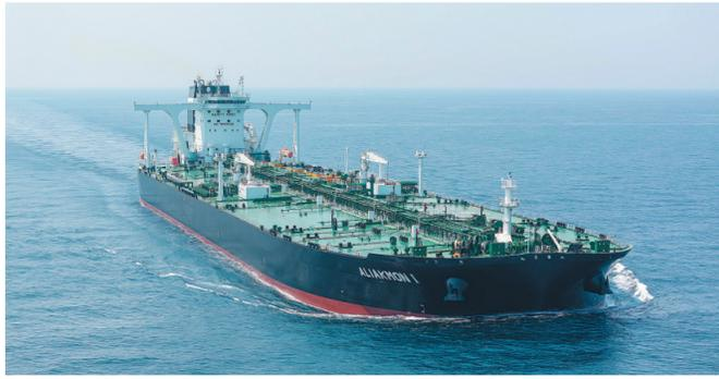
由恒力重工自主设计建造的首制30.6万载重吨超大型油轮(VLCC)成功交付。孙鹏伟 摄
