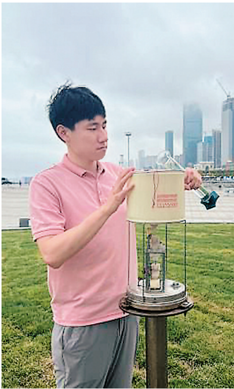
工作人员对自动气象站进行巡检核查。
