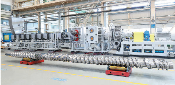
45万吨/年聚丙烯混炼挤压造粒机组。受访单位供图
